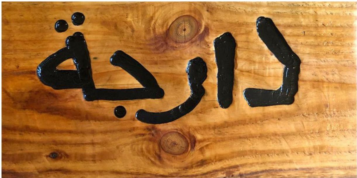
Test gravure sur pin Douglas, mot Derija. Defonceuse 10mm prof. 5mm, acrylique noir, ponçage, huile de lin térébenthine
